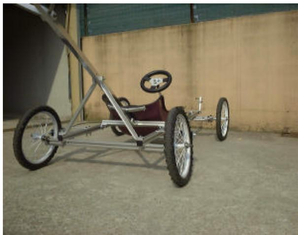
Il telaio interamente in alluminio ha un’elevata resistenza alla flessione, ma permette agli assali di torcere fungendo da ammortizzatori, efficace su fondi sconnessi e curve lunghe.
