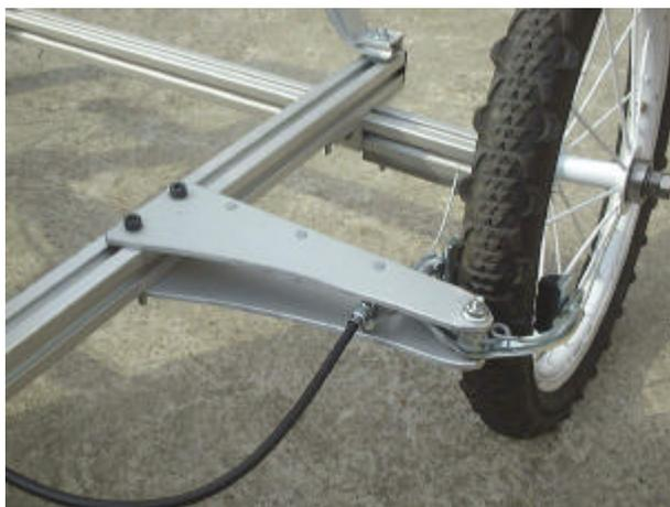
Un altro vantaggio non indifferente che questa vettura può offrire, è dato dal fatto che essendo assemblata senza alcun punto di saldatura, è facilmente modificabile nell’assetto, potendo variare le carreggiate anteriore e posteriore, l’altezza da terra e la lunghezza.
